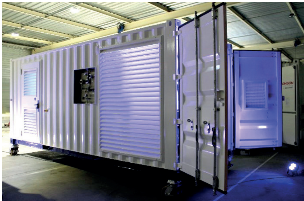
Station hydrogène 70kw
